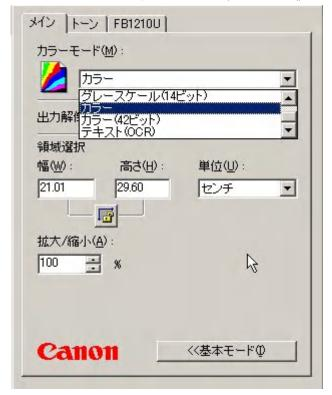
的にはスキャンする元データの種類に応じて、あらかじめ設定されている何種類かのモードからイメージタイプを選択すると、適正な出力解像度と階調の設定がされるようになっている。代表的なタイプをスキャナのマニュアルから引用すると次のようである。
