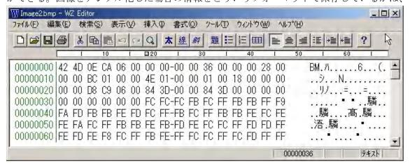
データのヘッダ部分に記録されている。図が BMP のヘッダ部分である。Windows は拡張子でファイルタイプを識別し、ヘッダ部分でフォーマットを読み込んで、それに基づいてデータを表示している。まれに拡張子を消してしまったり、違う拡張子に勝手に書き換えたりしてデータが開けないということがある。これは、拡張子を正しいものに直せば開けるようになる。ただし、拡張子とヘッダ部分の情報が矛盾していたり、ヘッダが壊れていたりすると開けなくなる。BMP はデータフォーマットが単純だが、その分データサイズが大きいという難点がある。用途としては Windows の壁紙やオフィスアプリケーションでの利用、Windows であればバージョンに関係なく利用でき、Mac や Unix でも対応ソフトがあるので、これらの間でデータを交換する場合にも利用できる。データ圧縮のないプレーンな画像データとして保存できるので、オリジナル画像を保存するのに適している。
