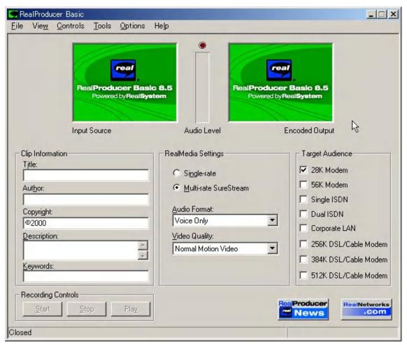
画面は Real Producer 8.5 Basic である。Producer は AVI や Quick Time ファイルを読み 込んでストリーミング用の RM ファイルに変換したり、ビデオ画像を取り込んで RM に変換したりすることができる。インターネットでストリーミングビデオを公開するためには、Windows ムービーメーカーの AFS 形式、Quick Time の MOV 形式、Real Video の RM 形式のいずれかのファイル形式になる。最も普及しているのは Real Video の RM で、画面のように Target を細かく設定できる。Wizard 形式で設定も簡単である。
