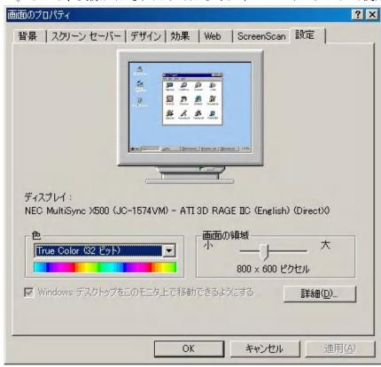
で決まる。左の例で は 800×600 ピクセ ルで True Color 32 ビットの設定になっ ている。ピクセルと は画素つまりドット の数を表す。色数が 32 ビットとは、ひと つの画素について 32 ビットつまり 4バ イトの情報を保持し ていることを表して いる。フルカラーは 通常 24 ビットなの で残りの8ビットは オーバーレイ表示な どに利用されている。
