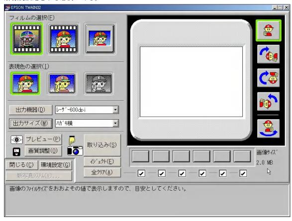
フィルムスキャナでは読取対象が 35 mm フィルムなので、 $35 \text{mm} \times 25 \text{ mm}$  のサイズになる。カラーリバーサルでは有効画素数は  $3,072 \times 2,048$  画素程度なので、2400 dpi で取れば写真画質になるが、プリンタが出力できなければ意味がない。それに読取後のデータ量は膨大になる。印刷出力が A4 で 600 dpi なら 35 mm を 297 mm に拡大することになるので、
